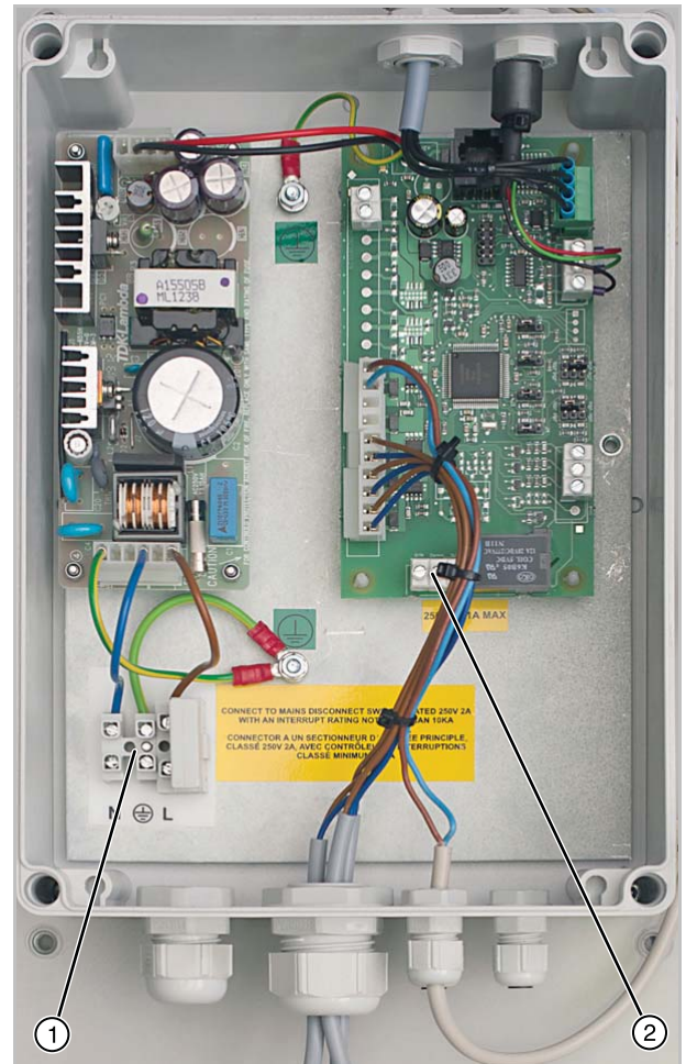
1 Bornier d'alimentation électrique : 2 Bornier d'alarme à distance
