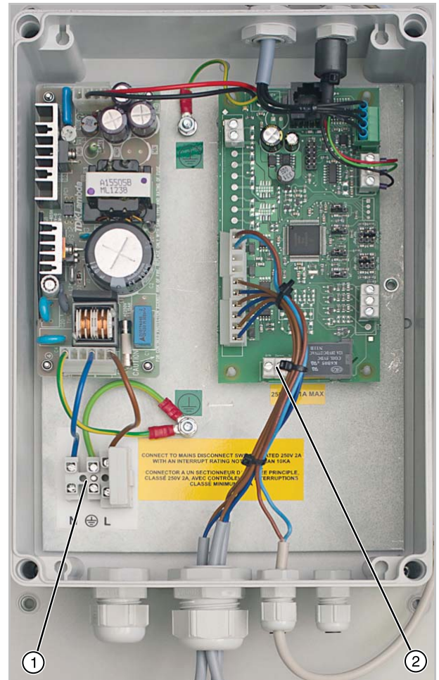
1 Klemmenblock für die Stromversorgung 2 Klemmenblock für Fernalarmlinien
