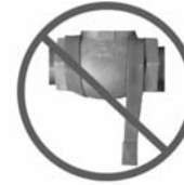
B) Installation incorrecte: Le ruban chauffant pend librement de la surface.
