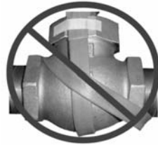
C.) Falsche Montage: Heizband überlappt sich
