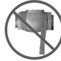
B.) Installazione errata: Nastro scaldante penzolante non aderente alla superficie
